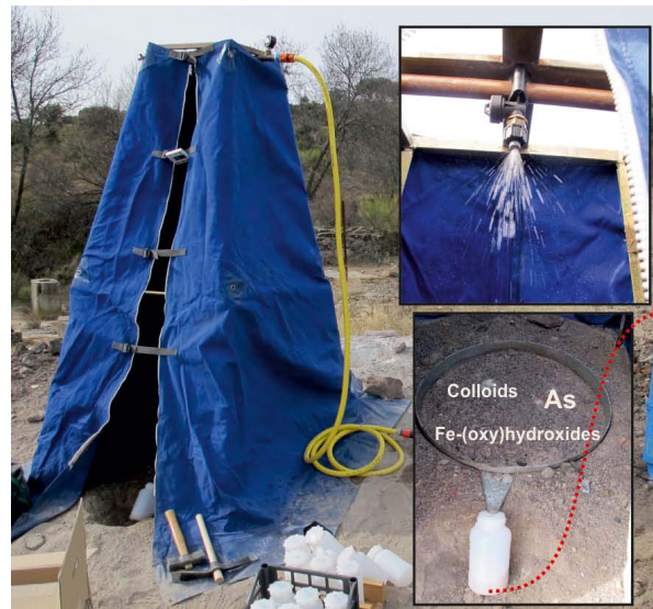
Imagen esquemática de los ensayos de simulación de lluvias llevados a cabo en la zona de Guadalix, junto con los principales resultados obtenidos representados gráficamente / Miguel Ángel Gómez González
